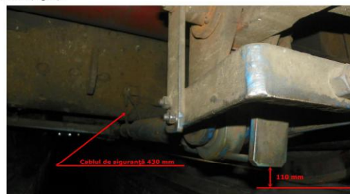
Fig.14. Distanța de la suprafața de rulare a șinei la capătul cu ureche al regulatorului automat de timonerie tip RL2-350 atunci când se sprijină pe legătura de siguranță de 430 mm.
