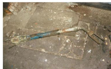
Fig.1. Regulatorul automat de timonerie tip RL2-350 de la osia nr.6 a locomotivei electrice EA 314
