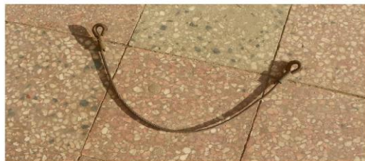
Fig.13. Cablul de siguranță a regulatorului de timonerie de 670 mm lungime
