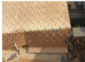
Fig.3 Dispozitivul ajutător de manevrare cu arc (DAM) aferent macazului nr.4
