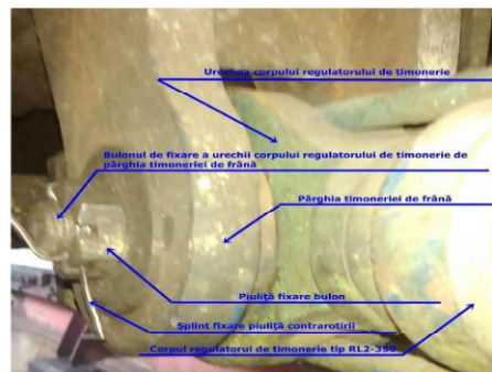
Fig. 9. Ansamblul de fixare a corpului regulatorului de timonerie tip RL2-350 de pârghia timoneriei de frână.
