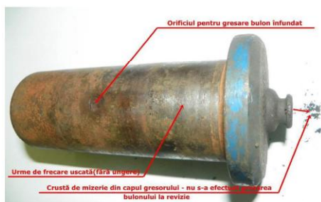
Fig.11. Bulonul de fixare a urechii corpului regulatorului automat de timonerie tip RL2-350 de pârghia timoneriei de frână – lipsă ungere (gresare).
