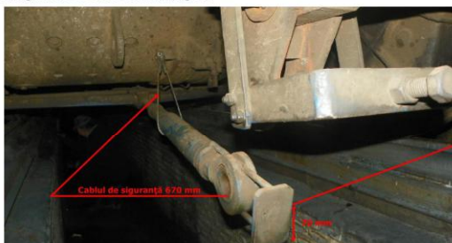
Fig.15. Distanța de la suprafața de rulare a șinei la capătul cu ureche al regulatorului automat de timonerie tip RL2-350 atunci când se sprijină pe legătura de siguranță de 670 mm.
